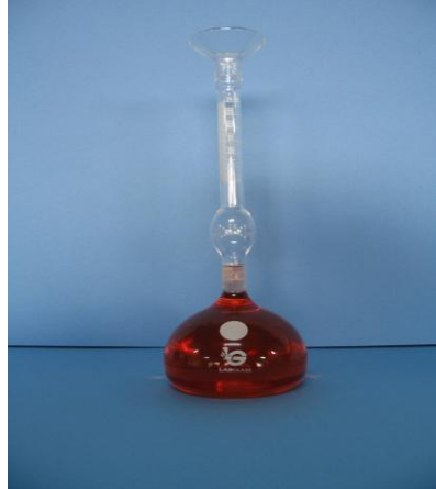
Fig. 1.2 Frasco Le Chatelier con gasolina
