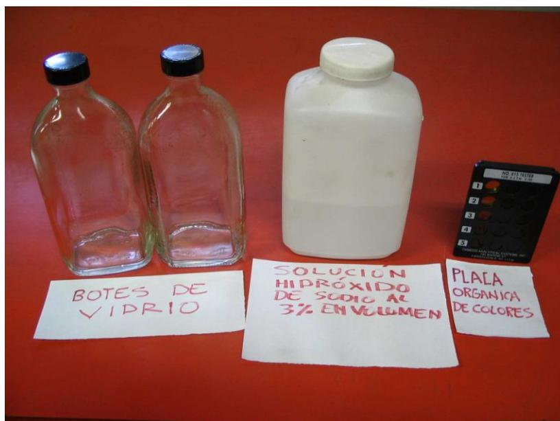
**Fig. 2 Equipo requerido para la realización del ensayo de impurezas orgánicas**
