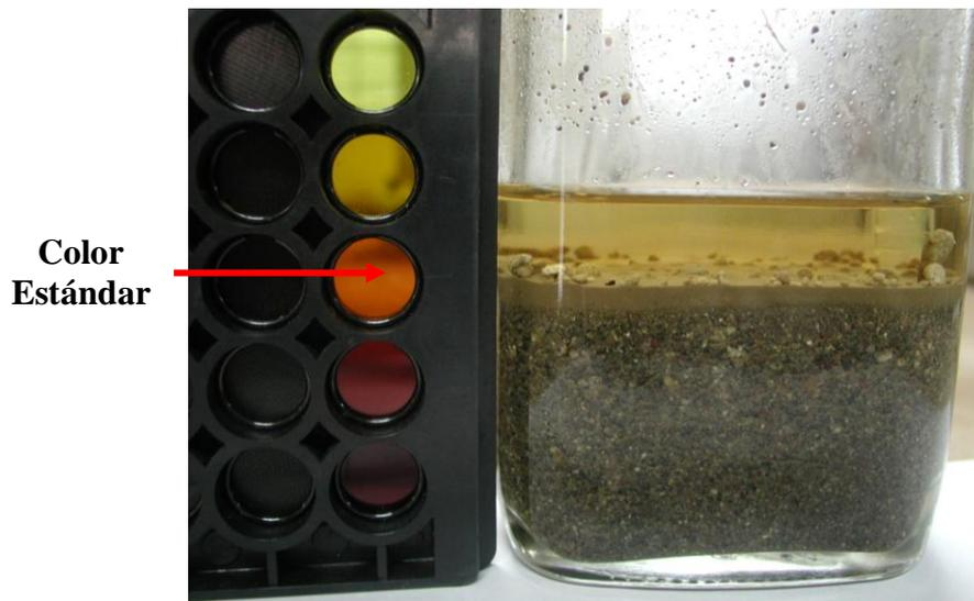
**Fig.1: Comparación de colores entre la solución con arena (luego de 24 horas) y la placa orgánica de colores Gardner.**
