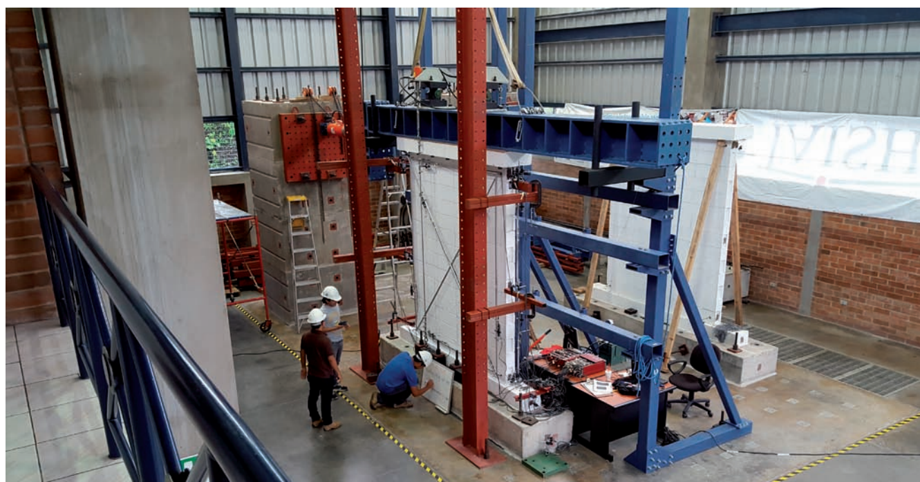
Pruebas realizadas en la investigación “Estudio del desempeño sísmico de viviendas de bloque de concreto reparadas”
