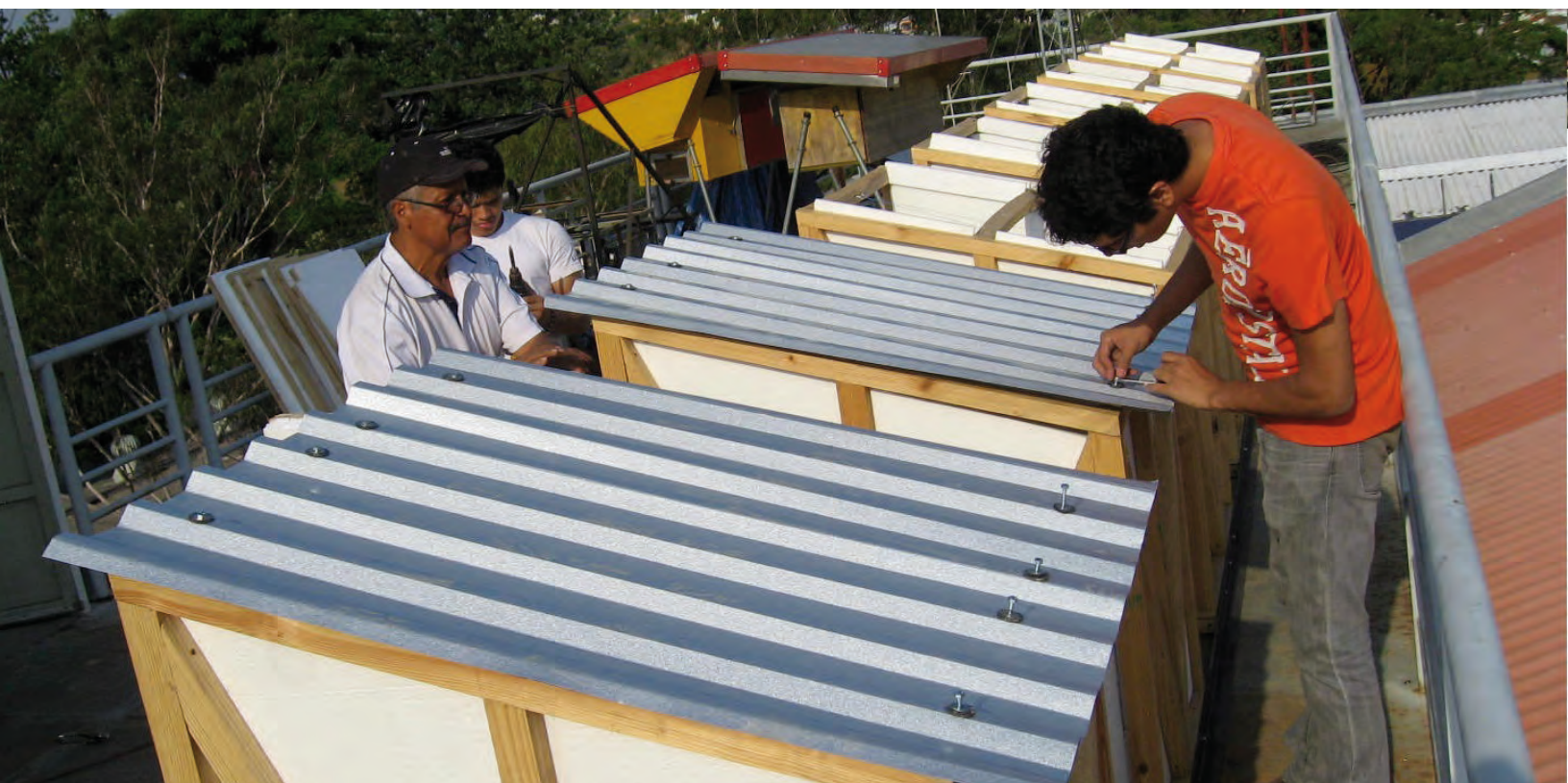
Montaje de Investigación Experimental del Comportamiento Térmico de Sistemas Constructivos para Cubierta.
