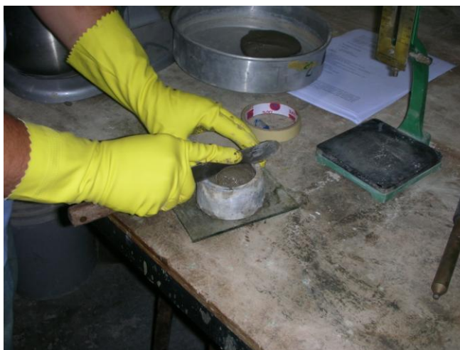
Fig 5-3. Colocación de pasta en el cono troncocónico y remoción de exceso
