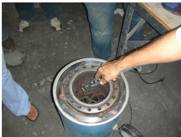
Fig 4-8 Colocación de agua de aproximadamente el 10 % del volumen del Autoclave
