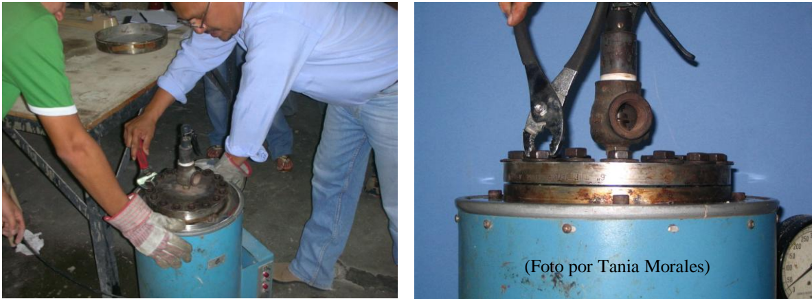
Fig 4-9 Preparación de Autoclave
