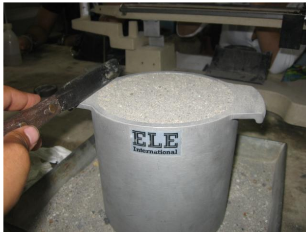
Fig. 4 nivelado de la superficie
