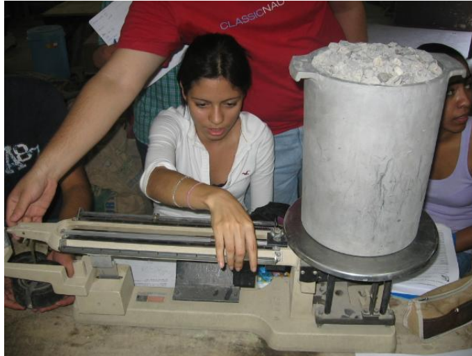
Fig 5. lectura del peso del molde mas agregado
