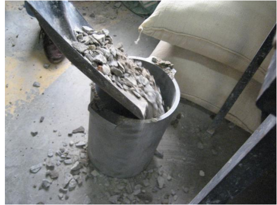
Fig. 2 colocación de los agregados en sus respectivos moldes
