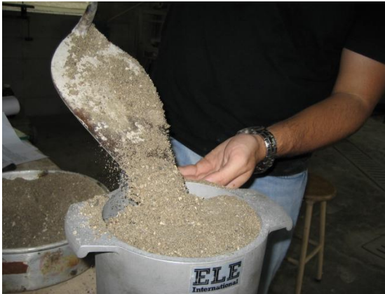
Fig. 2 colocación de los agregados en sus respectivos moldes
