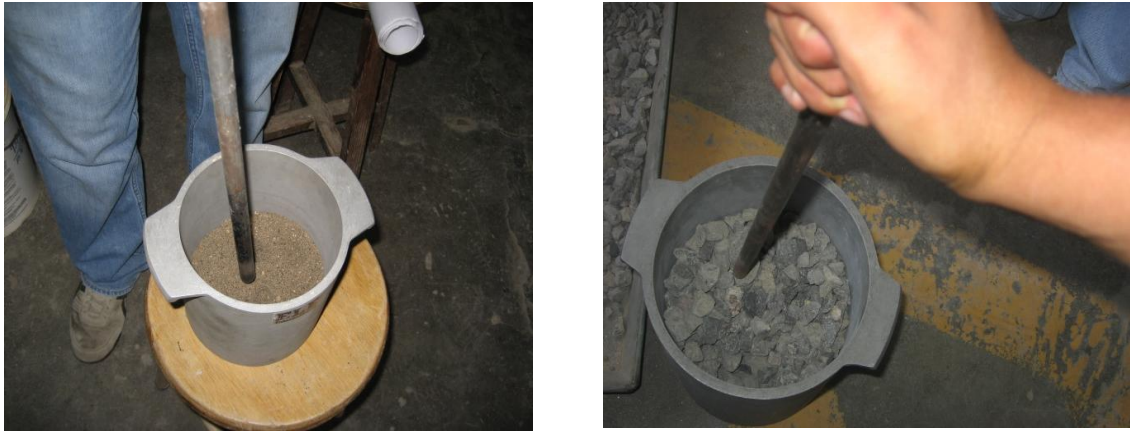
Fig. 3. varillado a n/3 de la capacidad de los moldes.
