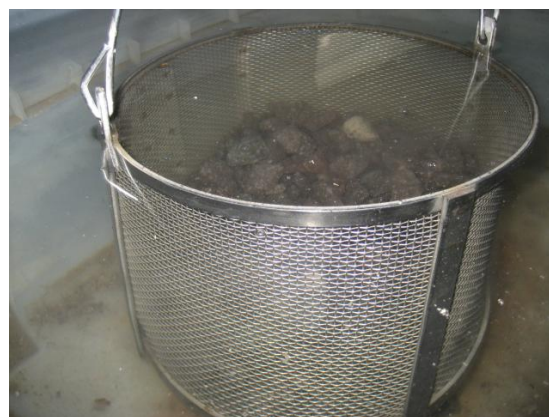
Figura 7 Determinación del peso de la muestra sumergida (peso aparente).
