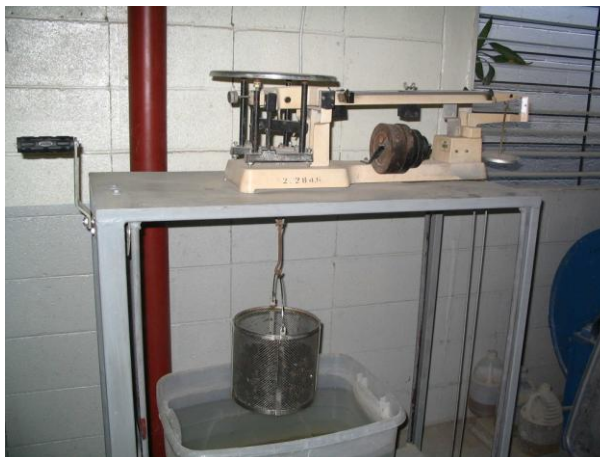
Fig. 6 Determinación de peso en el aire en condición saturado superficialmente seco
