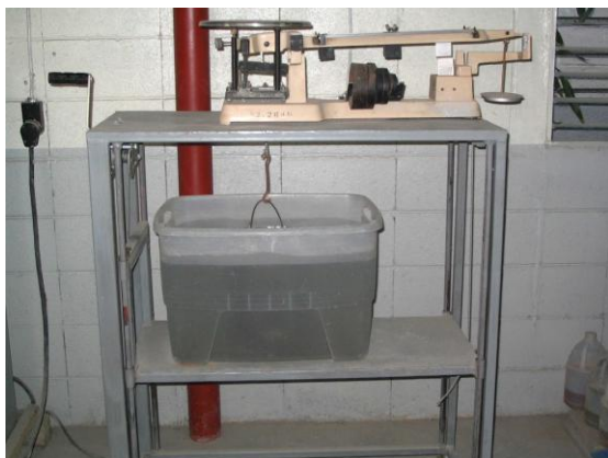
Figura 7 Determinación del peso de la muestra sumergida (peso aparente).
