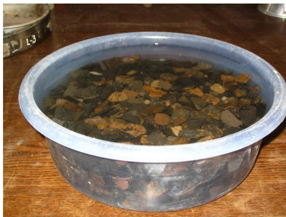
Figura 3 Grava en proceso de saturación.
