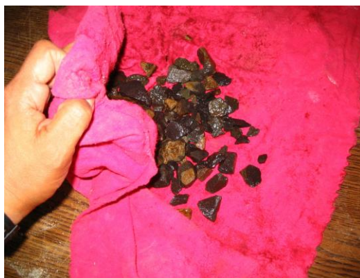
Fig. 5 Secado del agua superficial en la muestra.
